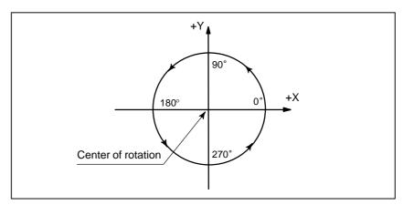
Fig. 14.11 (d) Angle of the C axis
