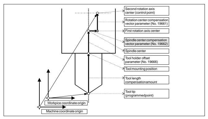
Fig. 22.4 (d) Spindle Center Compensation
