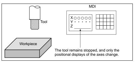
Fig. 1.4.2 Machine Lock
