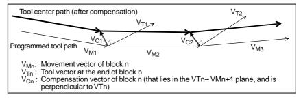
Fig. 22.5.2 (d) Operation in the compensation mode
