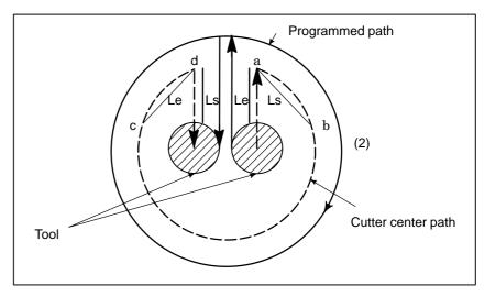
Fig. 5.4.2.1 (d) Override Range (Straight Line to Arc, Arc to Straight Line)
