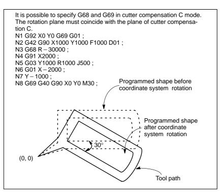
Fig. 14.10 (d) Cutter compensation C and coordinate system rotation
