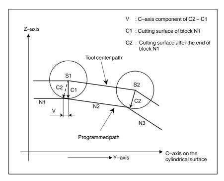
Fig. 22.2 (d) When Bit 6 (CYS) of Parameter No. 6004 Is Set to 1
